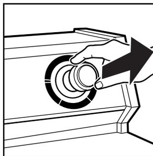
**REMARQUE :** Pour **arrêter** la laveuse à un moment quelconque, enfoncer le bouton de réglage de programme. Pour **remettre** la laveuse en marche, fermer le couvercle (s'il est ouvert) et tirer le bouton de réglage de programme.
