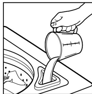
**liquide de blanchiment chloré** mesurée dans le distributeur de liquide de blanchiment chloré. Le liquide de blanchiment sera dilué automatiquement au cours de la partie de lavage du programme.
