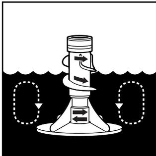
suscite une action continue de culbutage qui fournit un nettoyage en profondeur de la charge à laver.
